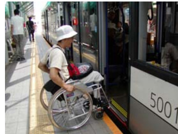
ホームとの段差がほとんどなく、車椅子などの乗り降りも楽に行え、 車内の段差もなく、移動もスムーズに行える 100%低床化された車両 (LRV-5000 超低床式「グリーンムーバー」広島電鉄)
